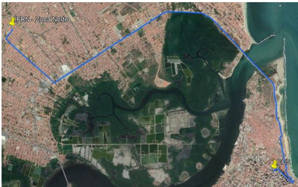
3. Necessidade de um par de fibra apagada, onde o trecho a ser cedido tenha obrigatoriamente origem no IFRN Ceará-Mirim até o IFRN São Gonçalo passando pela BR-40, a fim de gerar uma redundância física na atual Rede GigaNatal. Conforme imagem abaixo:
